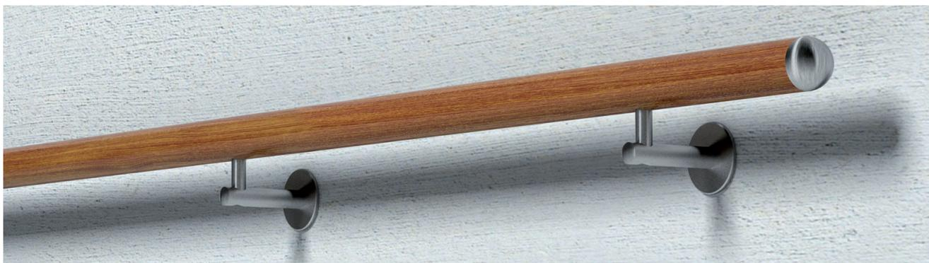
Mit Haltern ( HLTW-1080 ) / Edelstahlendkappen ( HOEL-00 ) / lichter Wandabstand 50mm / mit Befestigungsmaterial / erster Halter von aussen nach 150mm / lackiert
