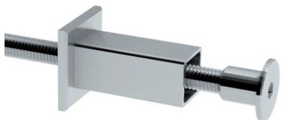
Postenhalter stirnseitig für flache Pfosten / Scheibe 35x35mm feingedreht / Distanzstück 20x20x2mm / Mat. V2A / Lieferung mit Gewindestange M10x330mm und Rundmutter M10
